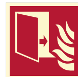
Fire protection door
