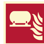
Fast brandsläckare installation
